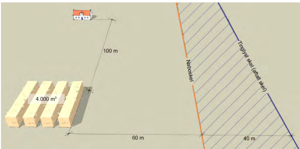
Figur 5.8: Figuren viser et halmoplag, som er placeret med en afstand 60 m til naboskel, men hvor der er lavet en aftale (servitut) med naboen, således at der opstår en afstand på 100 m til det fiktive skel. På den måde opfyldes forskrifternes punkt 5.2.1.
